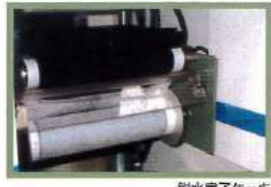
脱水完了ケーキ
