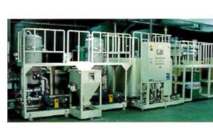
瞬間逆流・脱水機能付プレコート式精密汚過装置 RRF-80ASW+MCC-30FAS
