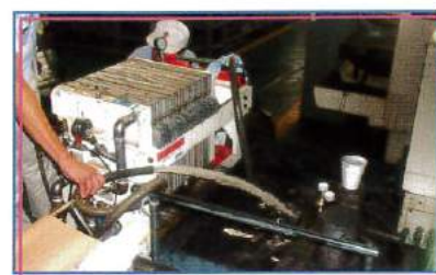
カスポンプレスMCP-4020 （超硬水溶性汙過、流量40ℓ/min）
