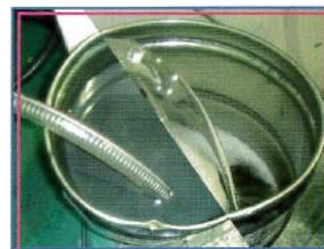
ラップ研磨油性原液と汙液 （アルミハイシリコン系）
