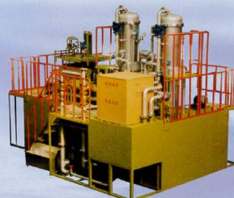
RRF-80ASW + MCC-40FAS (ライン集中設備一式、タンク10000リットル) W4000 X L6000 X H4700
