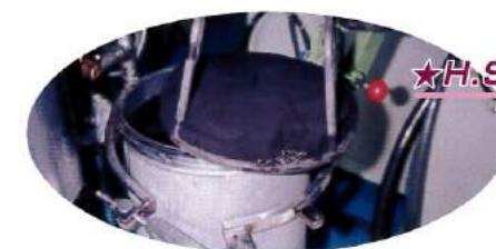
★TSAタイプ (10型タイプまで) 自動開放後、手でワンタッチ取出し。
